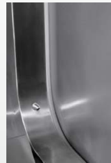
Aufblasbare Türdichtung, sepearte Ausblaseinheit an Tür
