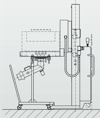
Aufnahmestellung für das Systemrohr
