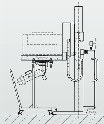
Position de mise en place du tube de chute sous le conteneur
